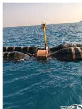
รูปที่ 3-36 อุปกรณ์ตัดแยกน้ำมันฉุกเฉิน (Break Away Coupling)
