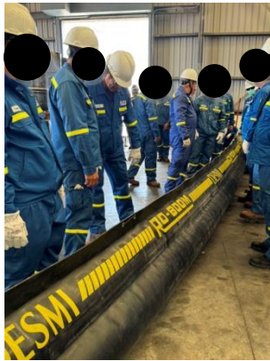
รูปที่ 3-14 ท่อนักน้ำมันชายทะเล
