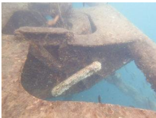
รูปที่ 3-39 ระบบป้องกันการกัดกร่อน
